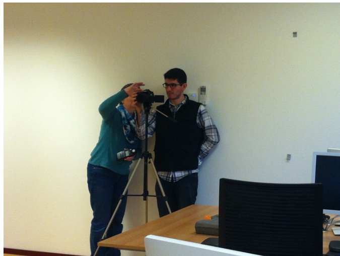
Figuur 2. De luminantie-camera is een gewone fotocamera, maar heel nauwkeurig gekalibreerd voor bijvoorbeeld lensfouten. De camera maakt een normale, een overbelichte en een onderbelichte foto direct achter elkaar en een computerprogramma maakt hiervan een luminantie-afbeelding.
